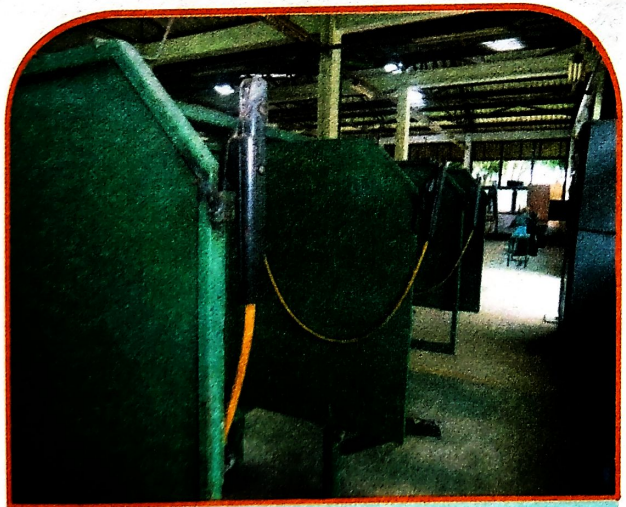
ภาพที่ 1.5 แสดงฉากกันระหว่างผู้เชื่อม เพื่อป้องกันแสงรบกวน
