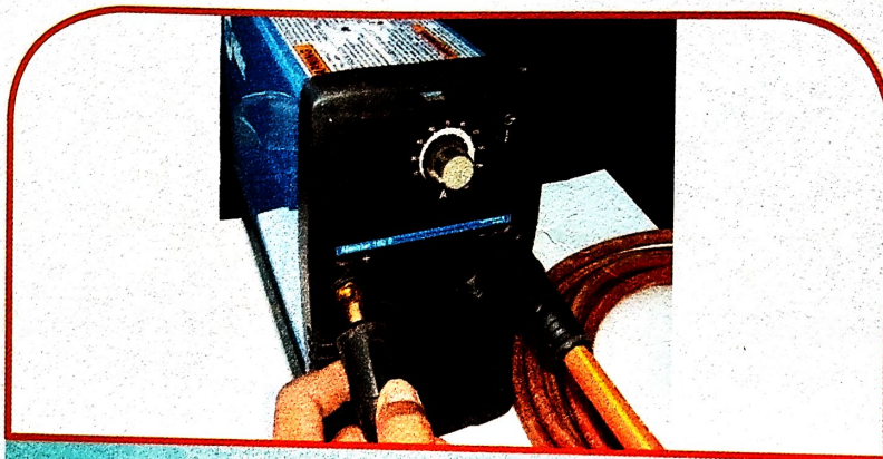
ภาพที่ 1.43 แสดงการนำสายเชื่อมและสายดินที่ยึดข้อต่อเรียบร้อยแล้ว เชื่อมเข้ากับเครื่องเชื่อม
